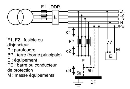
**F2 OBLIGATOIRE** si **F1** > calibre max. Protection du neutre obligatoire. d1+d2+d3 : distance la plus courte possible (< 50 cm recommandée). Terre : liaison 5a ou 5b.
